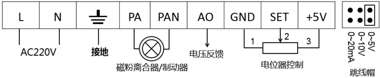
2. 外接P L C控制：跳线帽的位置根据 PLC输出类型而定:
